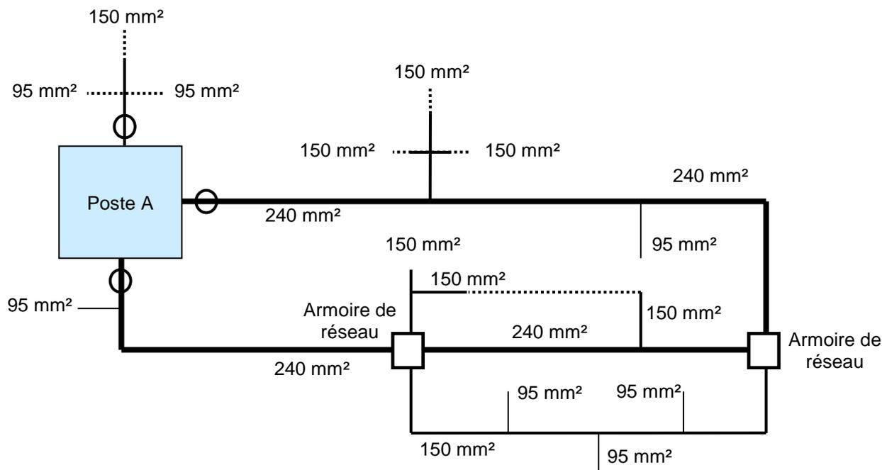
Les intensités maximales admises doivent être minorées par les facteurs de correction précisés au §5.6 de la norme NF C 14-100, lorsque les câbles enterrés cheminent en parallèle (écartement de 20 cm), avec ou sans fourreau. Cette réduction de capacité est à appliquer uniquement lors d'un parcours commun supérieur à 10 mètres.
