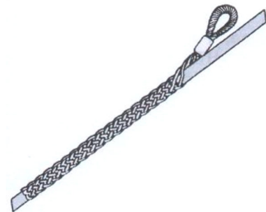
Chaussette de tirage du câble.
