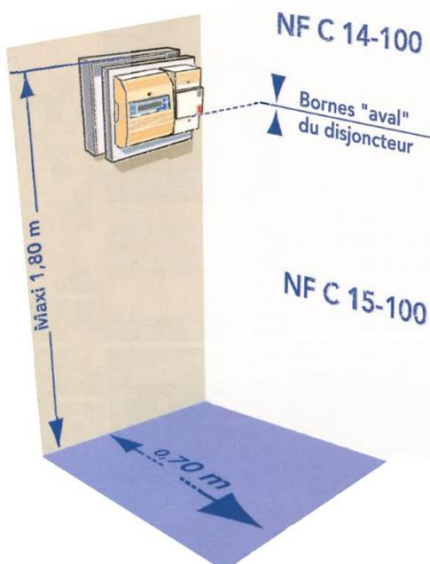
Le compteur et le disjoncteur sont posés sur un panneau support à une hauteur de 1,80 m, haut de panneau :
