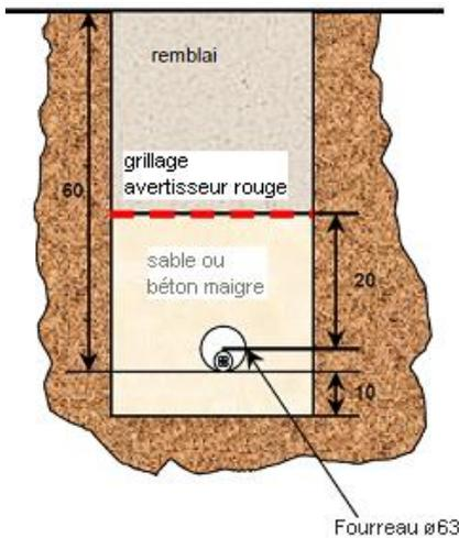
Il est usuellement demandé pour la dérivation individuelle un fourreau  $\varnothing$  63 mm, enterré à 60 cm minimum et il est conseillé de l'enrober de béton léger. Un dispositif avertisseur rouge est déroulé à environ 20 cm au-dessus du fourreau.
