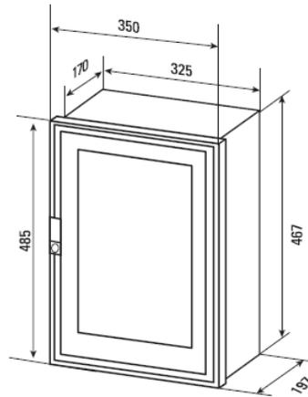
Coffret, avec panneau bois pour compteur/disjoncteur mono ou platine plastique pour compteur/disjoncteur tri, de couleur beige, sans embase téléreport et signe éclair. Spécification technique HN 62-S-20.
