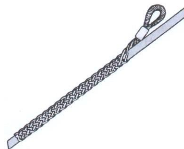
Chaussette de tirage du câble.
