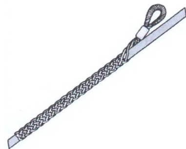
Chaussette de tirage du câble.
