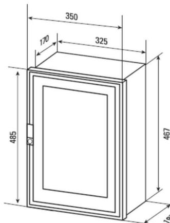
Coffret, avec panneau bois pour compteur/disjoncteur mono ou platine plastique pour compteur/disjoncteur tri, de couleur beige, sans embase téléport et signe éclair. Spécification technique HN 62-S-20.
