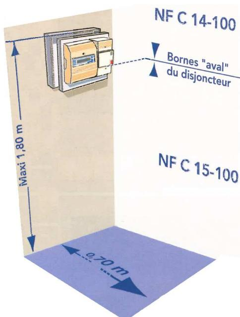
Le compteur et le disjoncteur sont posés sur un panneau support à une hauteur de 1,80 m, haut de panneau :
