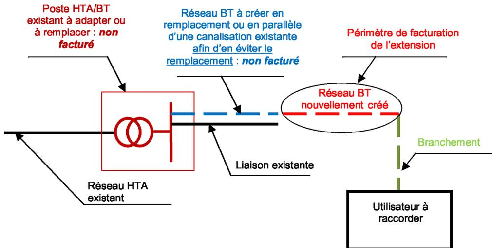
Lorsque l'opération de raccordement de référence consiste à créer un nouveau poste HTA/BT, le périmètre de facturation de l'extension comprend les frais correspondant à la création d'un poste HTA/BT et son alimentation HTA, ainsi que la création du départ BT permettant de raccorder l'installation.
