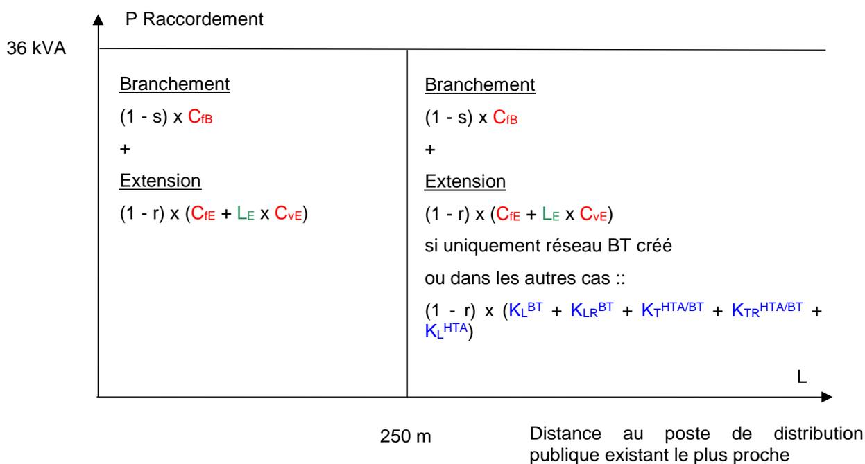
$$\text{Longueur totale du raccordement} = L = L_B + L_E$$
