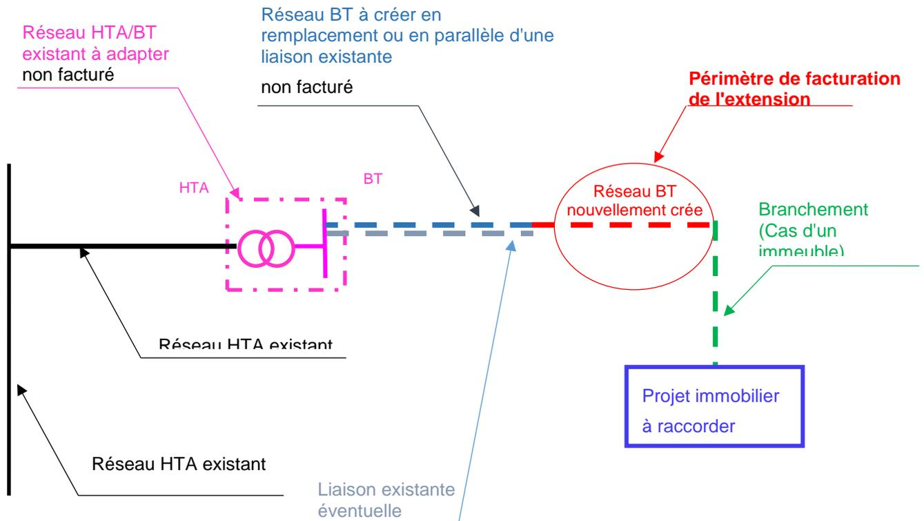
Lorsque l'opération de raccordement de référence consiste à créer un nouveau poste HTA/BT, le périmètre de facturation intègre la création d'un poste de transformation HTA/BT, la canalisation HTA nouvellement créée pour raccorder ce poste, ainsi que la création de la canalisation BT.
