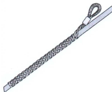
Chaussette de tirage du câble.
