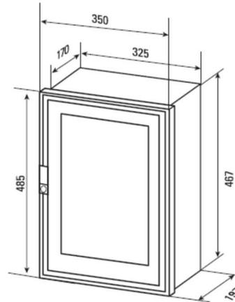
Coffret, avec panneau bois pour compteur/disjoncteur mono ou platine plastique pour compteur/disjoncteur tri, de couleur beige, avec embase téléport et signe éclair. Spécification technique HN 62-S-20.
