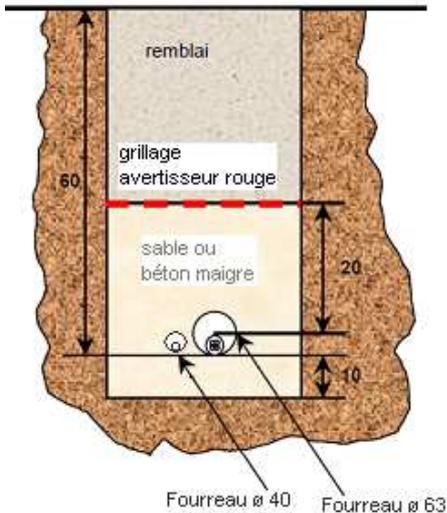
Il est usuellement demandé pour la dérivation individuelle un fourreau  $\varnothing$  63 mm et pour le câble téléreport un fourreau  $\varnothing$  40 mm. Ces fourreaux sont enterrés à 60 cm minimum et il est conseillé de les enrober de béton. Un dispositif avertisseur rouge est déroulé à environ 20 cm au-dessus des fourreaux.
