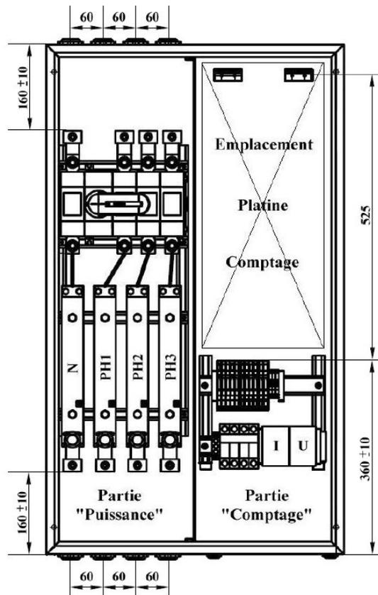
Armoire support de comptage 550 mm x 950 mm, profondeur 250 mm, destiné au compteur et au sectionneur à coupure visible.
