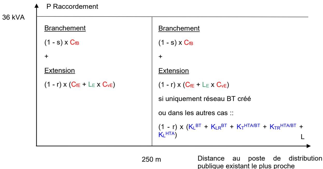
$$\text{Longueur totale du raccordement} = L = L_B + L_E$$
